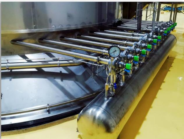
成熟的脉冲反吹型袋式除尘器。
